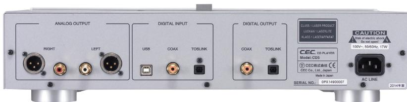
CD5のリア部。デジタル入力はUSB2.0(PCM32bit/32~384kHz、DSD64/2.8224~DSD128/5.6448MHz)、同軸(24bit/32~192kHz)、TOS(24bit/32~192kHz)の3系統。デジタル出力は同軸とTOSが各1系統。アナログ出力はRCAとXLR(2番ホット)が各1系統ずつ装備されている
